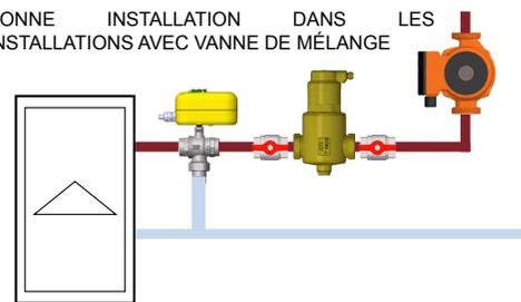
**⚠ Attention!** Pour un bon fonctionnement du dégazeur, celui-ci doit être installé en position verticale.
