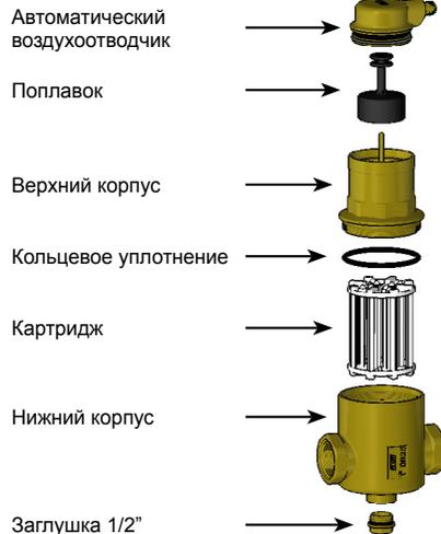
Верхняя часть автоматического воздухоотводчика поворачивается на 360° вокруг своей оси
