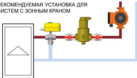
**⚠ Примечание!** Для эффективного функционирования деаэратора должен всегда устанавливаться в горизонтальном участке трубопровода с корпусом, направленным вверх.
